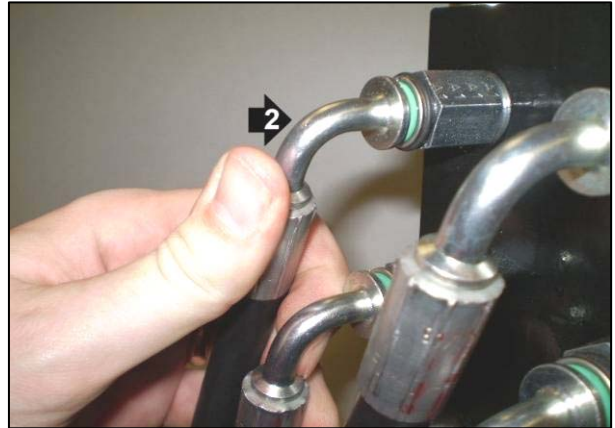
Anbauen: (1) Platzieren Sie das Schlauchende in die Gegenstelle. (2) Drücken Sie das Schlauchende in Position und ziehen sie zur Überprüfung daran.
