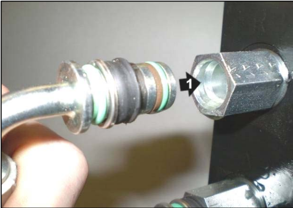
Anbauen: (1) Platzieren Sie das Schlauchende in die Gegenstelle. (2) Drücken Sie das Schlauchende in Position und ziehen sie zur Überprüfung daran.
