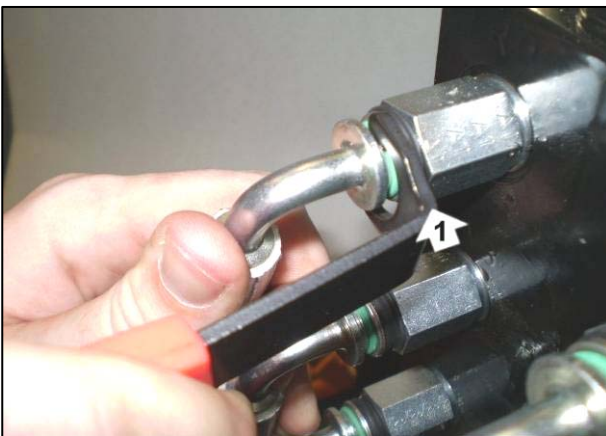
Abbauen: (1) Platzieren Sie das Werkzeug zum Abbauen hinter dem Ring am Schlauchende (2) nach vorne drücken
