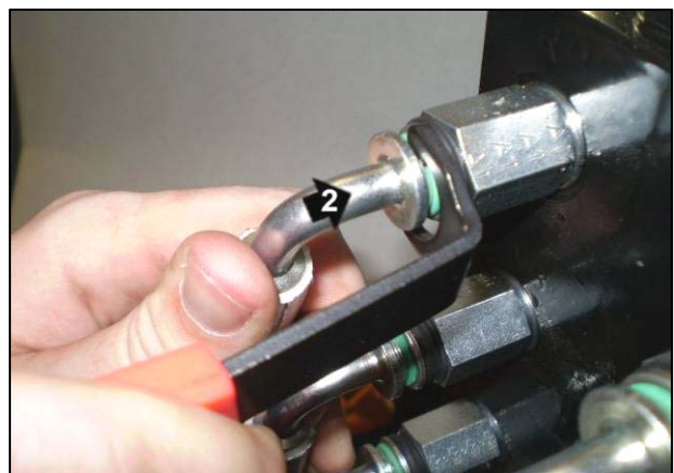
Abbauen: (1) Platzieren Sie das Werkzeug zum Abbauen hinter dem Ring am Schlauchende (2) nach vorne drücken
