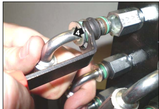
(3) Betätigen Sie das Werkzeug nach außen und lösen Sie das Anschlussstück (rückwärts) (4) nach hinten ziehen um den Schlauch abzubauen.
